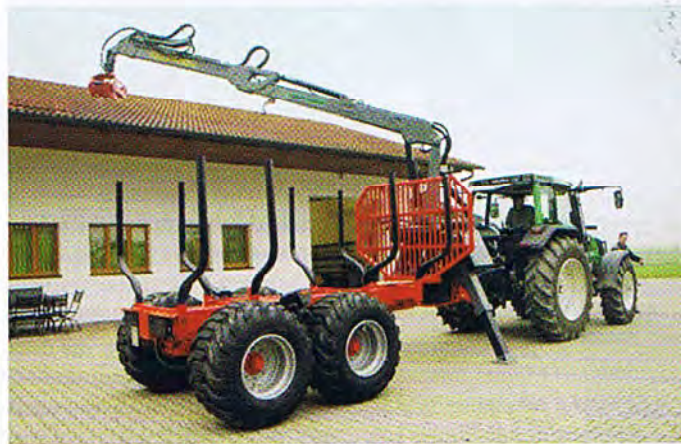
Ein Rückewagen aus der Unterreiner Forest-Master-Serie mit Radantrieb.
