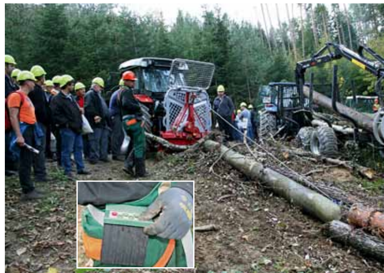
Die Tajfun-Seilwinde EGV 65 AHK kann per Funkfernbedienung von einem Forstarbeiter alleine bedient werden
