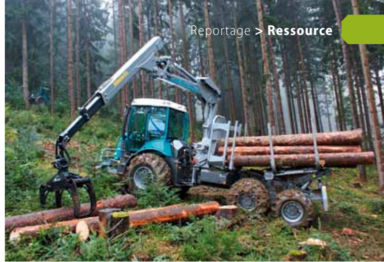
Forstspezialschlepper Felix beim Kurzholzrücken – die Maschine wurde mit vergrößerter Kabine und um 360° drehbarem Fahrerstand vorgeführt
