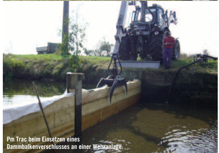
Trotz aufgebauter Seilwinde und Kran sind Heckhydraulik, Zapfwelle und Anhängerkupplung ohne Einschränkungen nutzbar.
