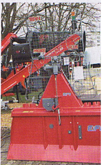
Die Seilwinde Titan SW 650 ProLine von EiFo warnt den Rücken, wenn ungeladene Personen im Umfeld sind
