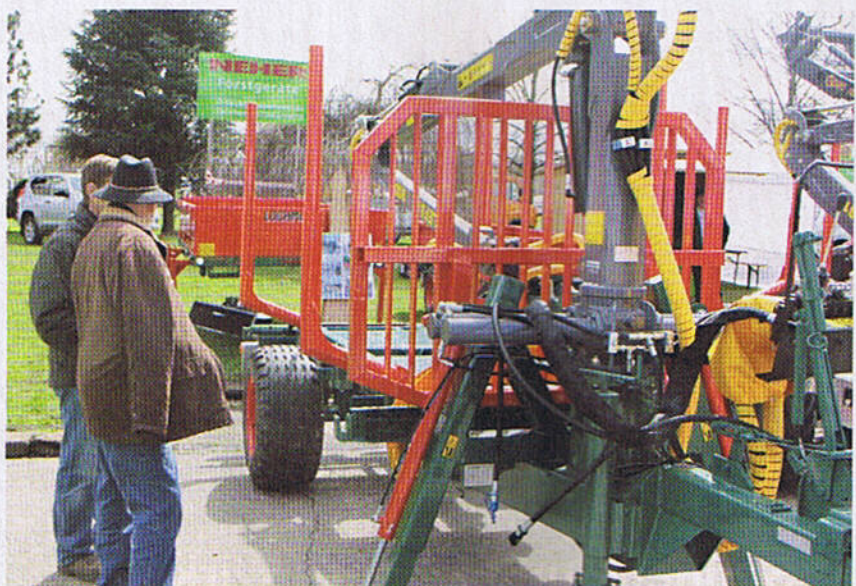
Auch für den Rückewagen der Firma Neher aus Wolpertswende gibt es eine Wechselbrücke, um den Anhänger vielseitiger nutzen zu können.
