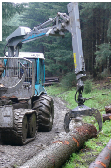
▼ Mit Klemmbank beim Langholzrücken
