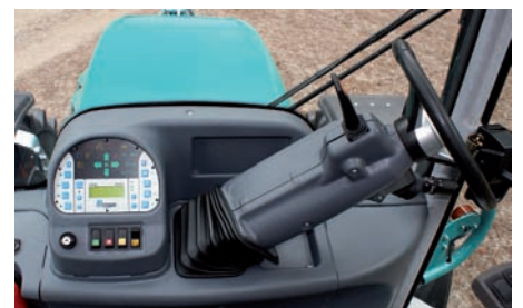
Die XXL-Kabine besitzt einen um 340 Grad drehbaren Bedienerstand. Unten: Bei der Arbeit im Forst wird das Lenkrad zur Seite geklappt und der Pm Trac per Joystick gelenkt.
