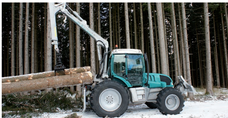
Durch die Anordnung der Kabine in der Fahrzeugmitte entsteht direkt über der Hinterachse der Aufbaureaum für den Kran und die Seilwinde. Fotos: Werk
