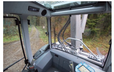
Die XXL-Kabine besitzt einen um 340 Grad drehbaren Bedienerstand. Unten: Bei der Arbeit im Forst wird das Lenkrad zur Seite geklappt und der Pm Trac per Joystick gelenkt.
