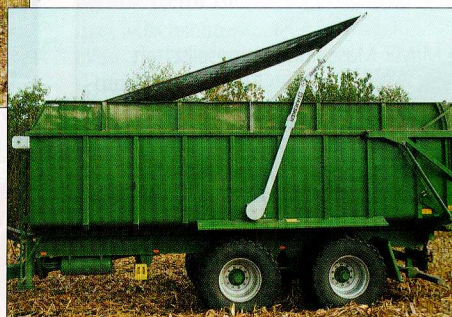
Der flexible Schwenkarm kann individuell zum Ladevolumen angepasst werden. Er wird oberhalb der Heckklappe geführt.
