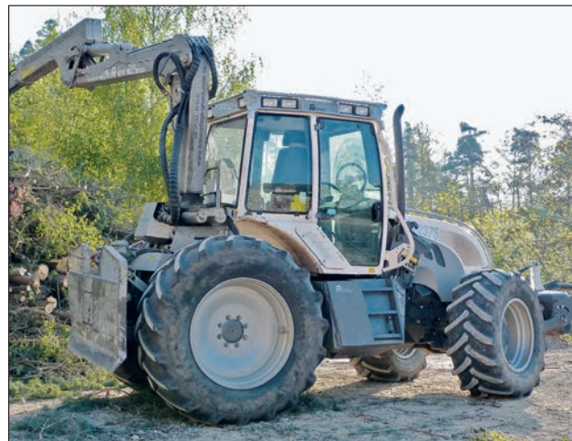
Dadurch, dass die Kabine beim „PM Trac“ nach vorne gerückt ist, können Winden und Kran über der Hinterachse montiert werden
