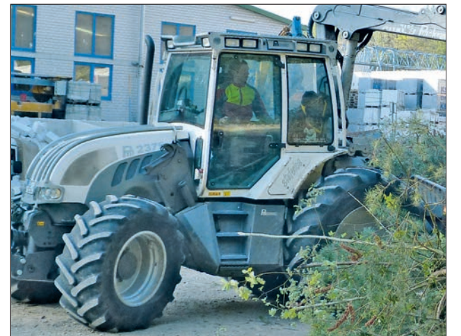
Die mittige Anordnung ermöglicht es, die Kabine so zu gestalten, dass ein drehbarer Sitz montiert werden kann. Dies erleichtert dem Maschinenführer die Arbeit
