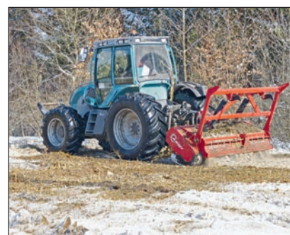
Neben dem Haupteinsatz bei der Rodung und Pflege von Trassen sind wichtige Einsatzgebiete für den „PM Trac“ bei Geisdörfer das Mulchen ...
