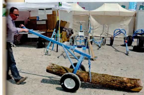
Wouter Crucke mit der Baumkarre „Junior“ (links) und dem Modell „Ultra“, bei dem während des Beladens das Rad hochgeklappt wird. Fotos: Riemann
