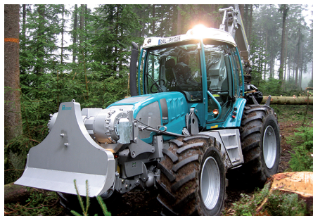
Durch die Anordnung der Kabine in der Fahrzeugmitte entsteht direkt über der Hinterachse der Aufbauraum für Kran und Seilwinde.
