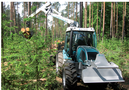
Durch die Anordnung der Kabine in der Fahrzeugmitte entsteht direkt über der Hinterachse der Aufbauraum für Kran und Seilwinde.
