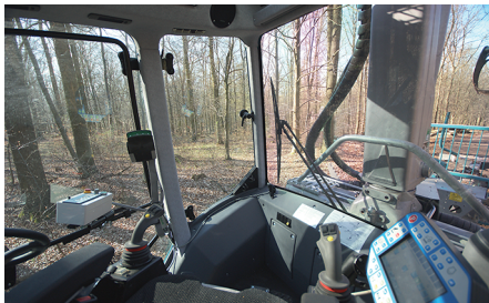
Pfanzelt XXL Kabine mit um 340° drehbarem Bedienerstand.
