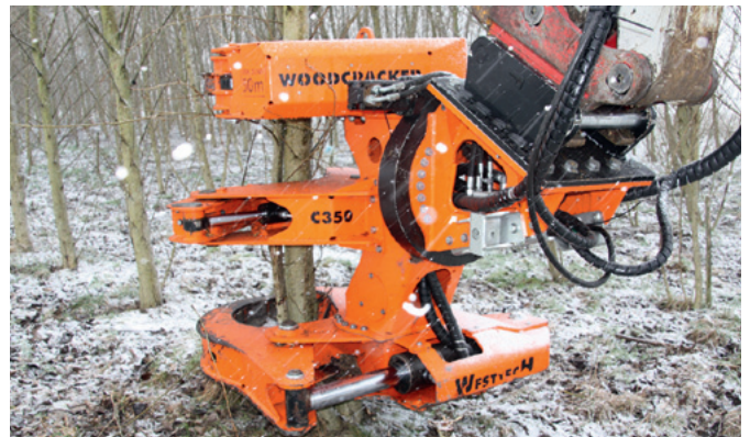
Woodcracker-Schneidkopf C350 von Westtech schafft Stammdurchmesser bis 35 cm und eignet sich für Baggeranbau (Einsatzgewicht: 14 bis 20 t)
