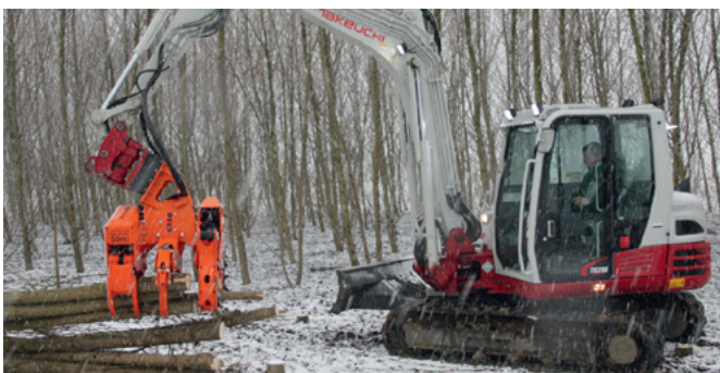
Mittels Sammelfunktion beim C250 können die geernteten Pappeln bündelweise für den Abtransport abgelegt werden
