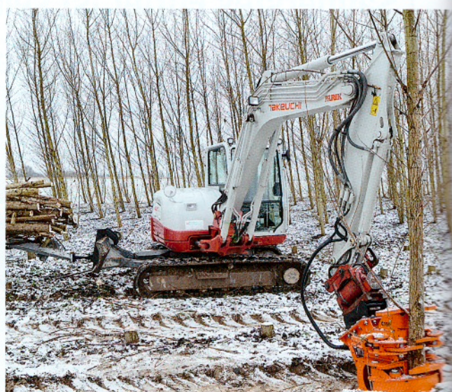
Ein C 150 mit starrer Montage auf einem 8 t-Bagger von Parik.
