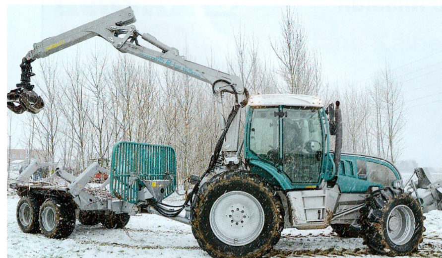
Gerückt wurde mit einem Pflanzel Systemschlepper Pm Trac III samt angebaurem Rückeanhänger mit woodZipper-Aufbau zur Komprimierung des geladenen Materials.
