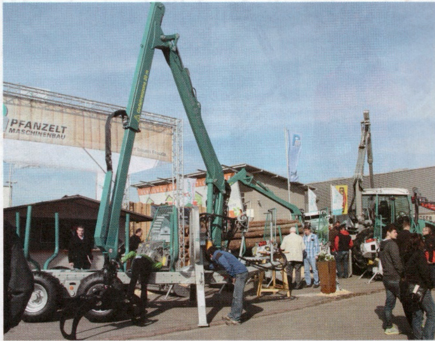
Die Firma Pfanzelt erweitert ihr Rückewagensortiment um drei größere Modelle von 15 bis 19 t Nutzlast. Eine hydraulische Deichsel sorgt für bequemes Fahren.
