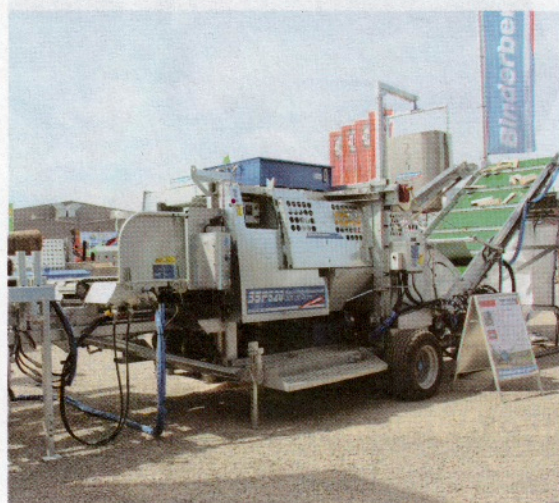
Das Besondere am Säge-Spaltautomaten, SSP 520 Pro D, von Binderberger ist das zweiteilige hydraulisch verstellbare Kastenkreuz. Die Scheitgröße kann schnell variiert werden.
