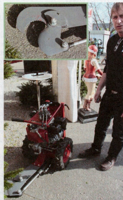
Der Cutter der Firma Treepacker aus Döbersdorf kann zusammengeklappt werden für den Transport.
