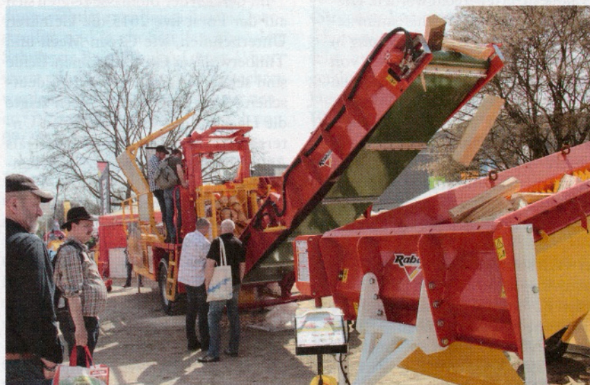
Die Firma Rabaud aus Cecile in Frankreich stellte den Sägespaltautomaten XyLog 550 vor. Dieser besitzt eine automatische Spaltkreuzeinstellung je nach Holzdurchmesser.
