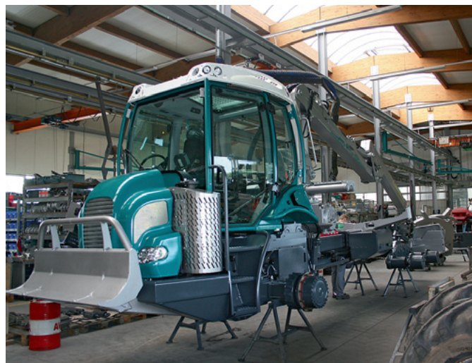
Forstspezialschlepper Felix bei der Endmontage
