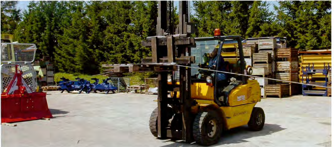
Ohne Prüfstand mutete eine Winden-Prüfung mitunter abenteuerlich an: Die Bremshaltekraft wurde durch das Aufbringen einer weiteren Kraft gemessen, wie bei dieser Gabelstapler-Methode. Solche Prüfungen benötigten sehr viel Platz und konnten einen ganzen Tag dauern. Fotos: Riemann (1), Baur (2), Riedel (1), Pfanzelt (1)
