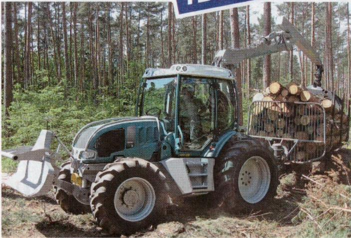
Der Pflanzelt Pm Trac 2380 4f zeichnet sich durch einen großen An- und Aufbauraum über der Hinterachse mit einem werkzeuglosen Schnellwechselsystem aus.
