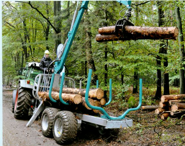
Der neue Pfanzelt-S6-Rückeanhänger besitzt einen geschraubten Doppelrohr-rahmen, um den Laderaum flexibel für unterschiedliche Stammlängen zu nutzen. Auch Meterholz läßt sich so ohne Umbauten laden. Fotos: Riemann
