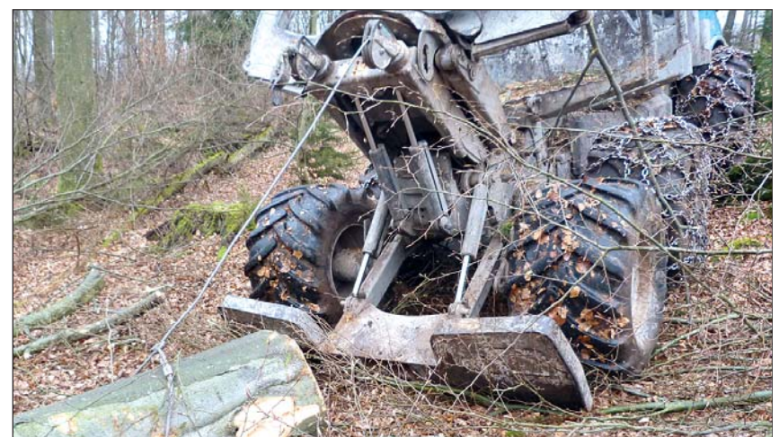
Beim Seilen leistet der hydraulisch höhenverstellbare Seilrollenbock hilfreiche Unterstützung, vor allem, wenn es in Hänge mit großen Blöcken geht
