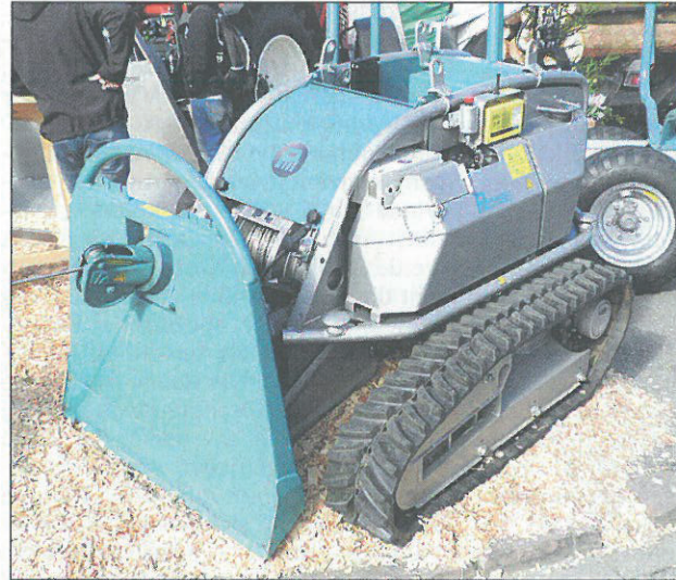
Ganz neu bei Pflanzelt ist die Fällraupe „PS RH – 1135/5“, die eine Alternative zum UVV-Schlepper sein soll.
