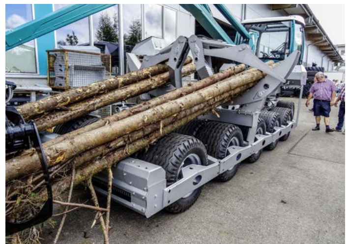
Fand Beachtung und warf Fragen auf: der Prototyp eines Rückewagens mit 22 breit bereiften Rädern für extrem feuchte Gebiete.
