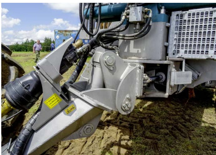
Für die Rückeanhänger hat Pfanzelt ein Deichseltilt-Federungssystem entwickelt. Es kann den Anhänger im Hang waagrecht stellen.
