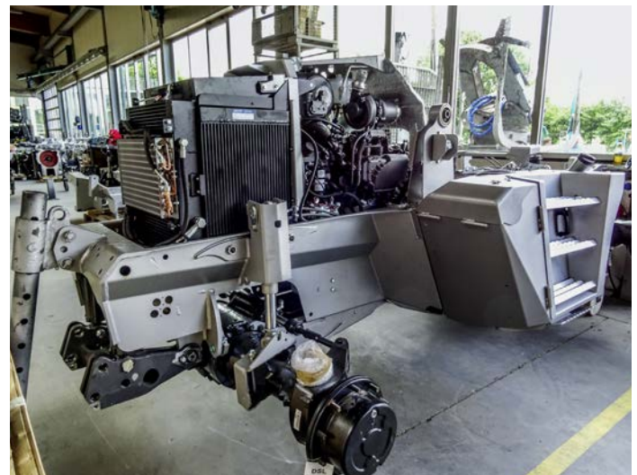
Hohe Fertigungstiefe: Nun wird bei Pfanzelt auch das Fahrzeugchassis des Systemtraktors «Pm Trac» selbst gebaut.
