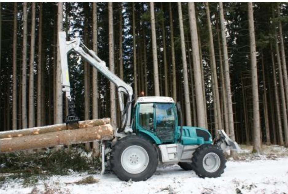
Abbildung 4: Durch die Anordnung der Kabine in der Fahrzeugmitte entsteht direkt über der Hinterachse der Aufbauraum für Kran und Seilwinde
