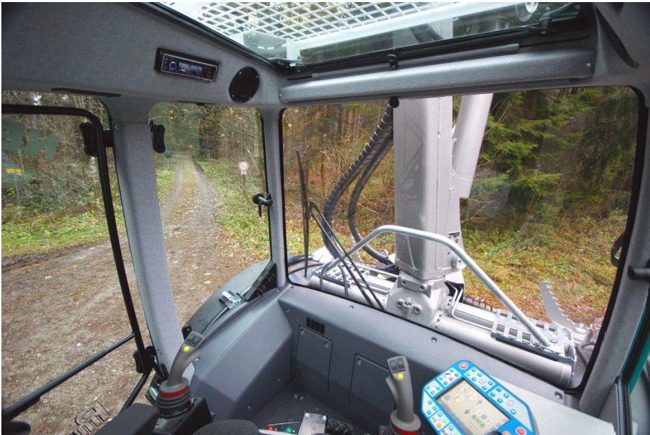
Abbildung 2: Pfanzelt XXL Kabine mit um 340° drehbarem Bedienerstand
