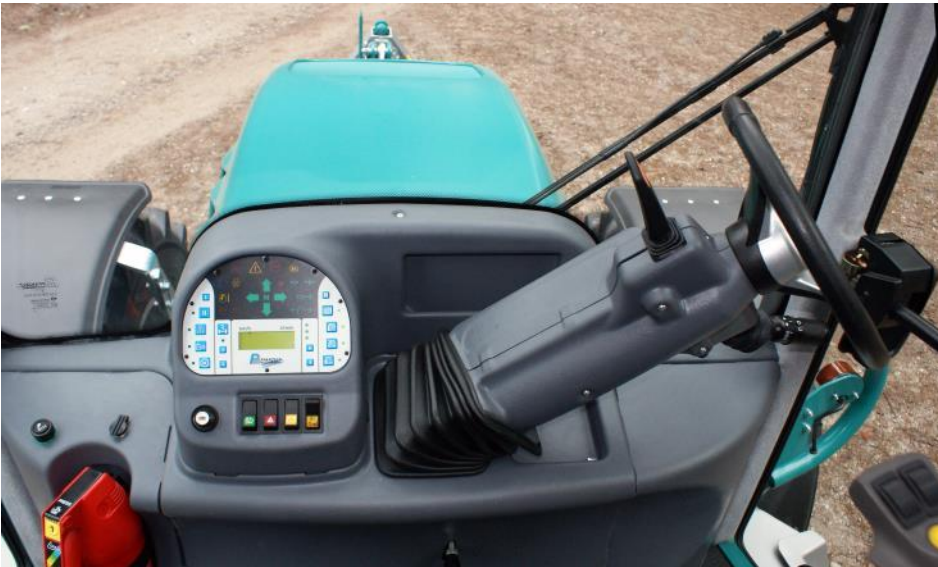
Abbildung 3: Für den Forstbetrieb wird das Lenkrad zur Seite geklappt und das Fahrzeug mit dem Joystick gelenkt
