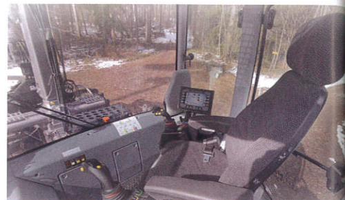
▲ Blick in die moderne Kabine, die mit einem Drehsitz aufwartet. Joysticks und Displays schwenken mit dem Fahrer.
