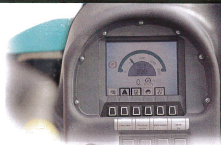
▲ Farbdisplay für Drehzahlanzeige.
