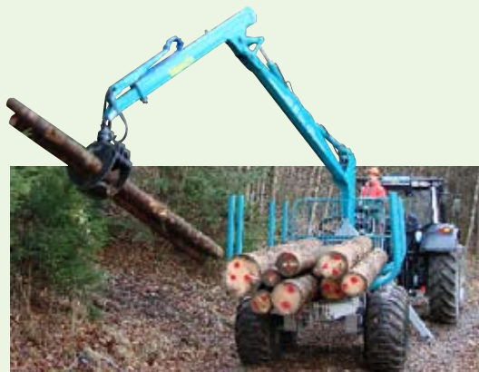
Der Kran LK 4177 leistet gute Arbeit. Sämtliche Funktionen lassen sich gut mischen und mehrere gleichzeitig ausführen.
