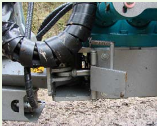
top Lösung für die Lenkdeichselarretierung: Zwei seitlich montierte, federgestützte Klappen greifen hier in das Gelenkfenster ein.
