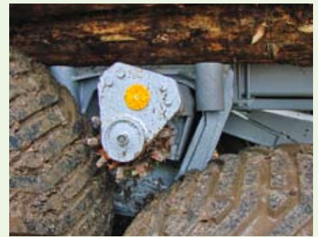
Der Allradantrieb macht den Hänger für Gelände bis 35% einsetzbar. Das doppelt gelagerte Sternrad wird dabei elektrohydraulisch in das Radprofil gedrückt.
