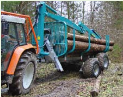
Durch den Pendelweg der Bogieachsen von 390 mm können Hindernisse gefahrlos überfahren werden.
