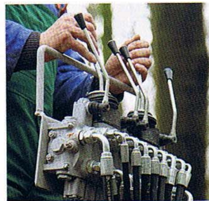
Die Kranbedienung kann entweder komplett mechanisch...
