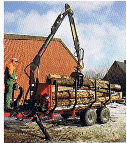
So genannte „Flap down“-Stützen (rechts) brauchen mehr Platz als die „A“-Abstützung (links), stehen aber auch sicherer. Hat der Knickarm oben keinen Kniehebel (rechts), ist er nicht so beweglich, und der außen liegende Teleskopzylinder ist ungeschützt. Sitzt sogar der Zylinder vom Hauptarm oberhalb (linkes Bild), ist auch hier die Beschädigungsgefahr geringer.
