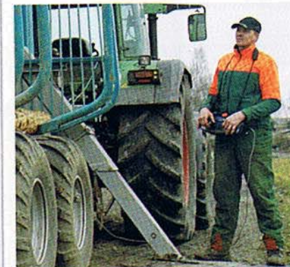
...oder komplett elektrisch per Kabel beziehungsweise Funk erfolgen.
