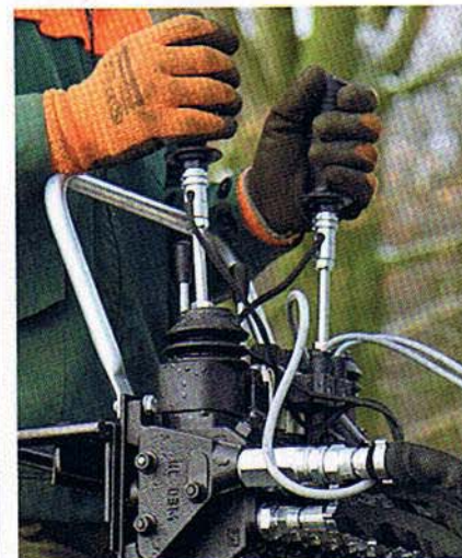
...mit elektrischen S/W-Ventilen für zwei Funktionen...
