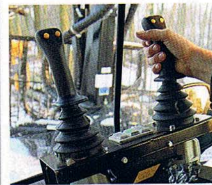
...mit Elektro-Proportionalsteuerung (EHC)...
