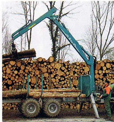
So genannte „Flap down“-Stützen (rechts) brauchen mehr Platz als die „A“-Abstützung (links), stehen aber auch sicherer. Hat der Knickarm oben keinen Kniehebel (rechts), ist er nicht so beweglich, und der außen liegende Teleskopzylinder ist ungeschützt. Sitzt sogar der Zylinder vom Hauptarm oberhalb (linkes Bild), ist auch hier die Beschädigungsgefahr geringer.
