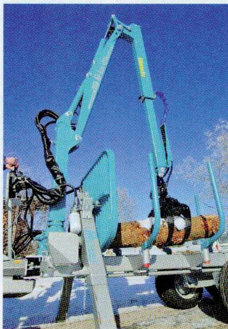
Erst der Kniehebel zwischen Haupt- und Knickarm macht den Kran richtig gelenkig.
