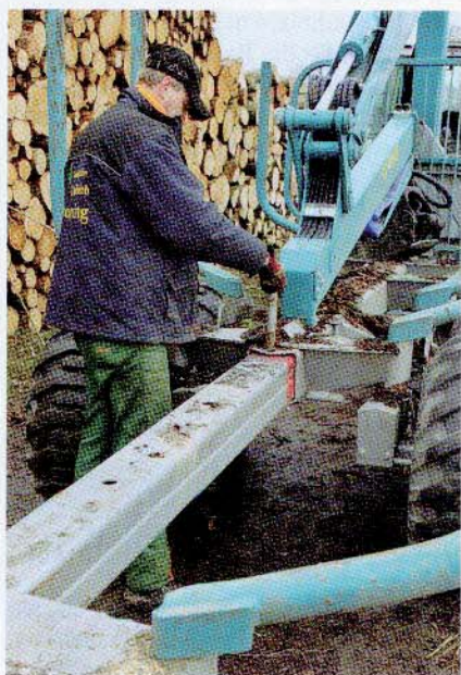
Rückewagen mit Zentralrohrchassis, ebenfalls mit auschiebbarem Heck.
