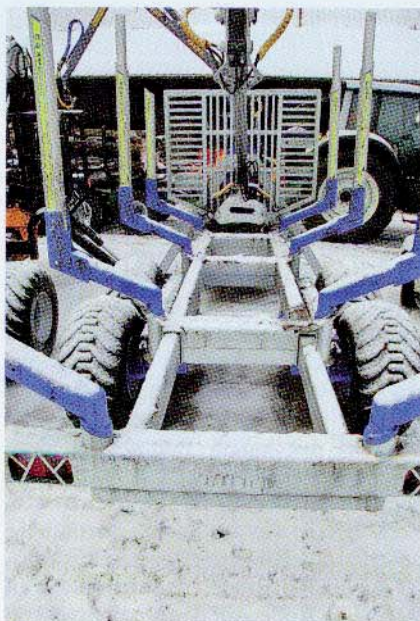
Rückewagen mit Leiterrahmen und auschiebbarem Heckteil.
