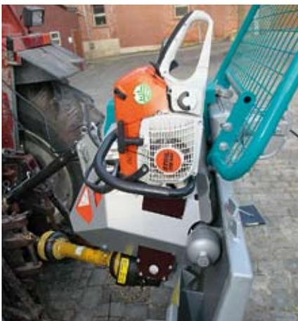
Unter dem Blech verbergen sich ein Stirnrad und ein Schneckengetriebe sowie die Ölpumpe. Es gibt zwei Staukästen mit Deckel sowie einen Halter für die Motorsäge.
