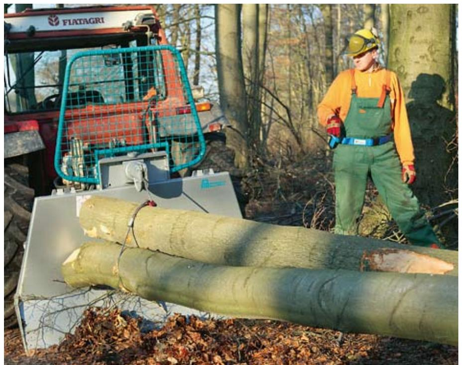
Mit der „S-line“-Baureihe bietet Pfanzelt zwei preiswerte Getriebe-Seilwinden mit maximal 55 bzw. 72 kN Zugkraft, die den professionellen Winden kaum nachstehen. Fotos: Wilmer
