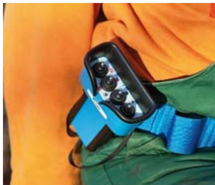
Die senkrechten Kippschalter erschweren die Bedienung, und es fehlte eine Ladeanzeige. Statt in den separaten Köcher steckt man die Einheit besser in die Schlaufe des Gürtels.
