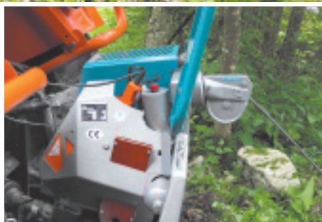
Die hoch liegende Seiltrommel ermöglicht eine horizontal befestigte Umlenkrolle.
