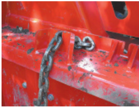
Kleinigkeiten, die nicht passieren sollten: Im rechten Bild passt die Kette nicht in die dafür vorgesehene Halterung.
