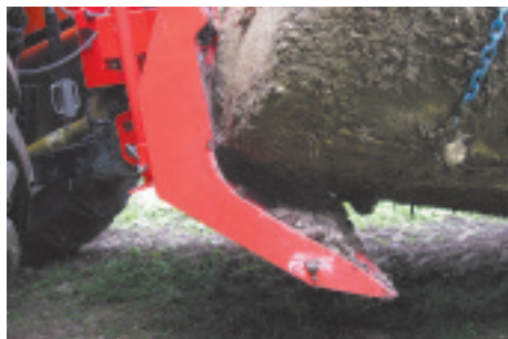
Eine flache Stellung erleichtert das Anheben der Bloche beim Poltern.
