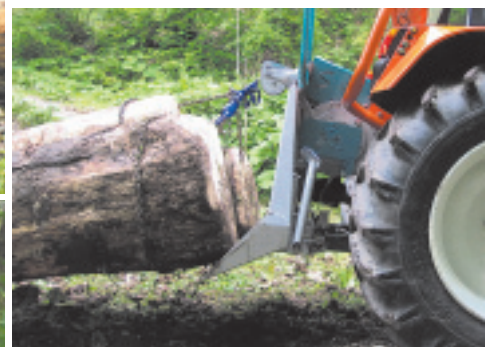
Bei hochgehobener Winde schlüpft der „Windenblock“ zwischen die Räder des Traktors.
