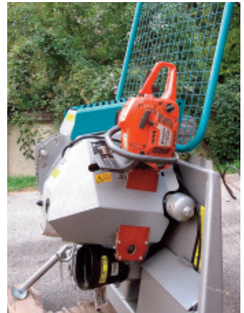
Praktische Halterungen für Motorsäge und Sappel erleichtern deren Transport.
