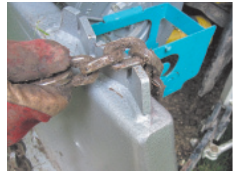
Kleinigkeiten, die nicht passieren sollten: Im rechten Bild passt die Kette nicht in die dafür vorgesehene Halterung.
