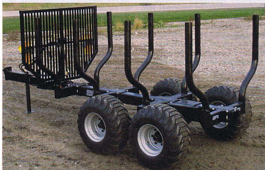
Abb. 3: Dieser Forstanhänger der Firma Palms mit einem Zentralrohr wird von Einsiedler Forsttechnik aus Bad Grönenbach vertrieben. Die Rungs können leicht verschoben werden. Foto: EIFo
