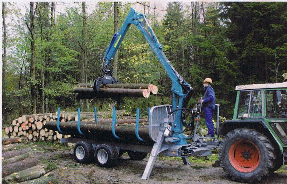
Abb. 1: Der Rückeanhänger 9242 S-line der Firma Pflanzelt mit 9,2 t Nutzlast. Die Nutzlast wird im Wald angegeben, auf der Straße gilt jedoch das Zulässige Gesamtgewicht. Je schneller man auf der Straße fahren möchte, desto weniger darf geladen werden.
