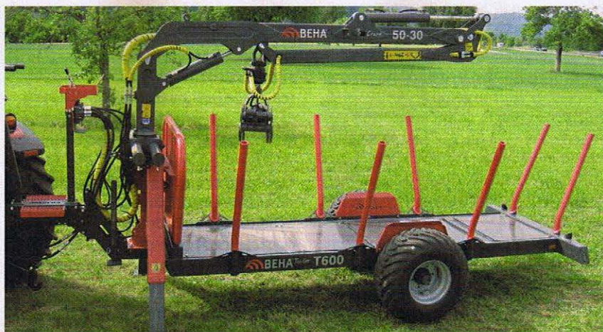
Abb. 2: Der Trailer T 600 von der Firma Beha mit Ladepritsche und U-Profilen. Beha wird zur KWF-Tagung eine neue Serie auf den Markt bringen mit einem robusteren Kran. Firma Oehler Maschinenbau aus Offenburg vertreibt den U-Profil-Forstanhänger OL EHK 80 für 8 t bereits mit TÜV. Foto: Beha
