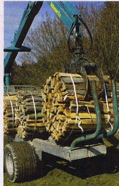
Abb. 4: Hier kann auch quer geladen werden indem die Rungen um 90° gedreht werden.
