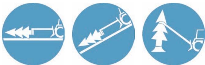
In diesen drei Rückesituationen leistet eine Seilwinde wertvolle Zugarbeit: bei normaler Seilrückung im ebenen Gelände, bei der erschwerten Seilrückung im Steilhang und bei der Problembaumfällung mit Seilsicherung.
