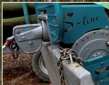
Die Seiltrommel im Inneren der Winde macht den Unterschied beim Seileinlauf. Je breiter die Trommel, desto weniger Seil wird übereinander gewickelt und somit Seilverknötung verhindert. Außerdem entstehen nur geringe Zugkraftverluste.
