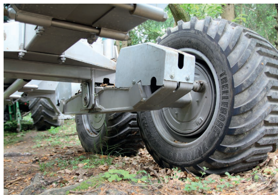
Die schwenkende Boogieachse ist robust ausgeführt. Gebremst wird die Anlage über eine Druckluftbremse.
