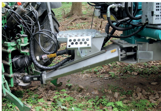
Dank einer Knickdeichsel lässt sich die Maschine im Wald besser manövrieren.
