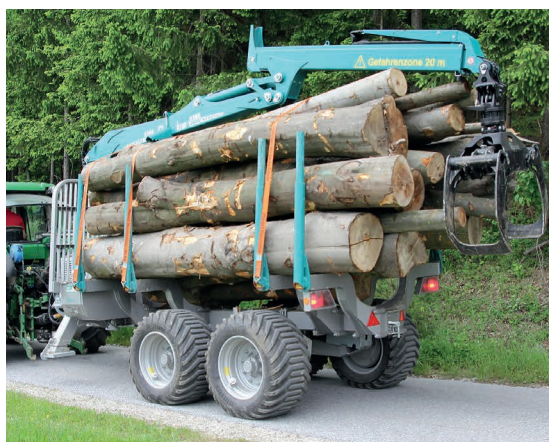
Für Fahrten auf der Straße lässt sich die Ladung über Zurrgurte sicher fixieren.
