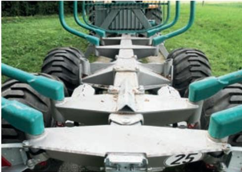
Die Rungenstöcke und das Achsaggregat sind am Zentralrohrrahmen geklemmt.
