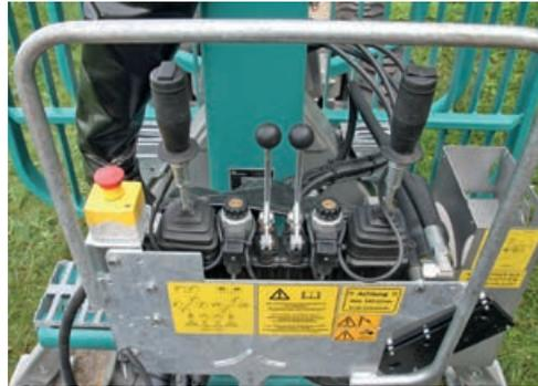
Mit den beiden Kreuzhebeln und den beiden Tastern lässt sich der Kran feinfühlig steuern.
