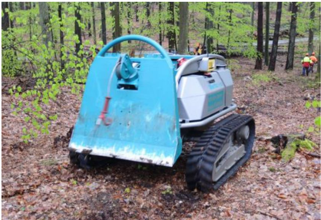
Fäll- und Rückeraupe Pfanzelt Moritz Fr50 mit Eintrommelwinde
