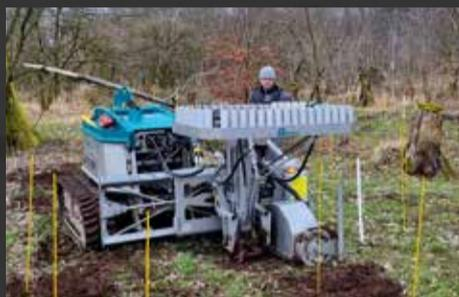
Die Lösung für die maschinelle Wiederbewaldung und das naturnahe Aufforsten großer, aber auch kleinstrukturierter Flächen ist die Kombination aus Forstraupen und Containerpflanzmaschine. Die Pflanzmaschine ist mit einer hydraulisch angetriebenen Frässcheibe ausgestattet um das Pflanzbeet von ungewolltem Aufwuchs und Waldboden zu befreien.
