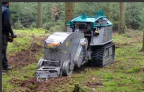
Zusammen mit der Sä-Streifenfräse ist der Moritz die Lösung für den naturnahen Waldumbau. Die Sä-Streifenfräse kann sowohl in Beständen wie auch auf Freiflächen eingesetzt werden. Je nach Bewuchs kann die Kombination mit oder ohne vorherigen Einsatz einer Forstfräse am Moritz eingesetzt werden. Die Streifenfräse bereitet das Saatbeet vor und die aufgesattelte Säeinheit legt das Saatgut ab und schließt die Furche zuverlässig.
