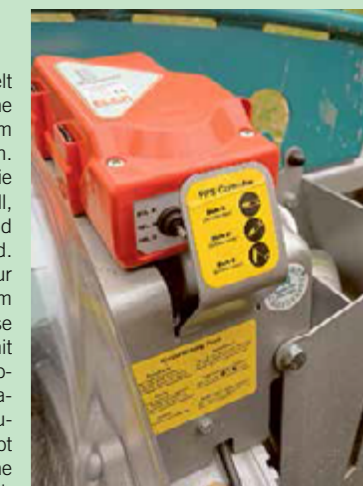
Pfanzels Präzisionssteuerung passt die Überschnellung von Kupplung und Bremse an die Rückesituation an.
