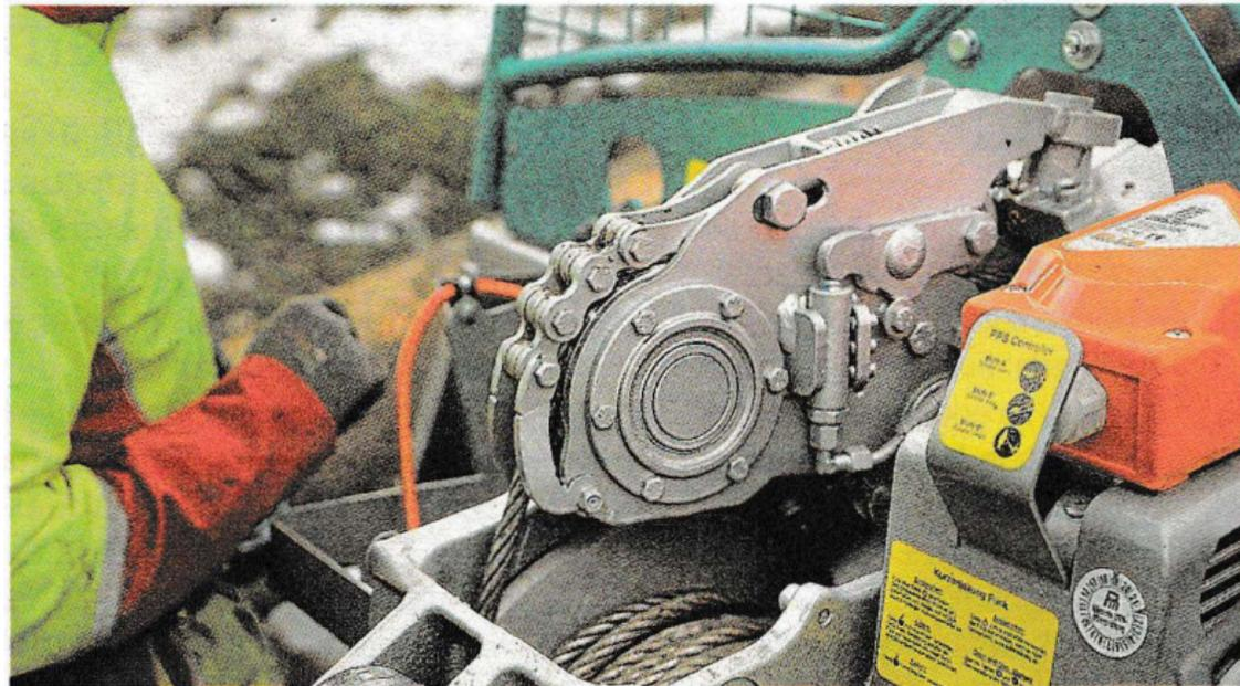
**Der optional erhältliche Seilausstoß und die automatisierte Trommelnachlaufbremse erhöhen die Sicherheit und den Bedienkomfort der S-Line Winden.**
