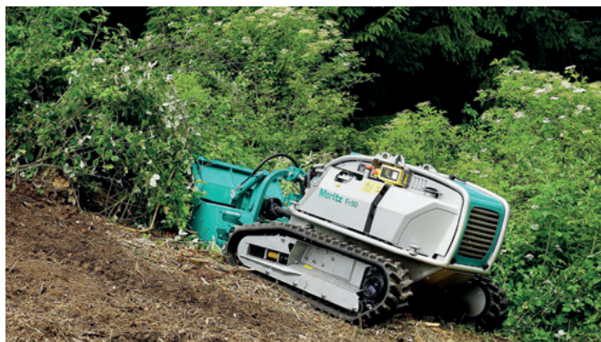
Der neue Moritz: hier mit einer Forstfräse im Einsatz
