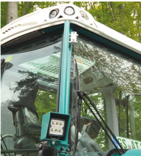
Links: Die Dachleuchten sind in LED-Technik gehalten, ebenso die Zusatzleuchten an der Kabinensäule.
