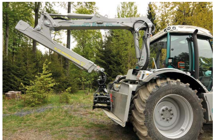
Unten: Bei Fahrten im Bestand wird der Kran auf dem Heckschild abgelegt, damit nichts wackelt oder schlägt.
