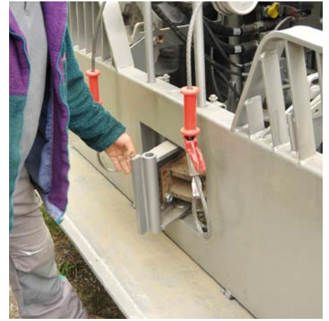
Rechts: In der Mitte des Klappschildes kann die Anhängerkupplung weggedreht werden und dann ist die Prallwand eine ebene Fläche, nichts stört oder steht hervor.
