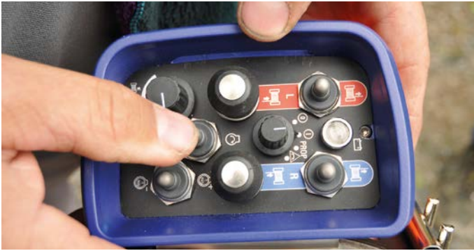
Oben: Die Funkfernbedienung mit Start/Stopp-Einrichtung, Windenbedienung, Gasverstellung ... und dem Starterknopf für die Frontzapfwelle (unten).
