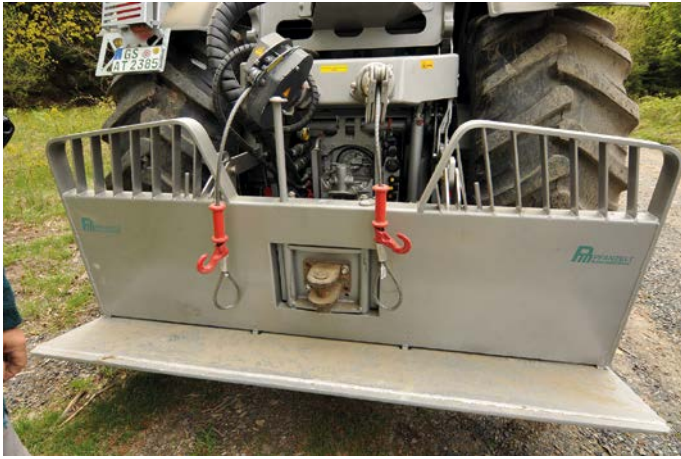
Links: Hier passt was rauf und es schont Kran und Seile. Das Klappschild hinten.
