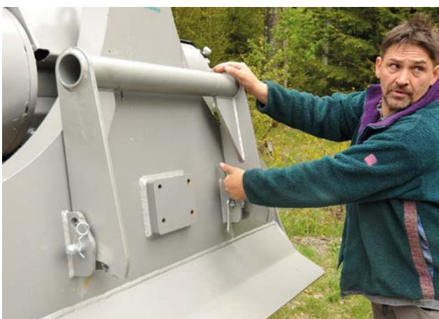
Links: Das 900 Kilogramm schwere Frontpolsterschild dient als Kranablage und kann mit ein paar Handgriffen abgebaut werden.
