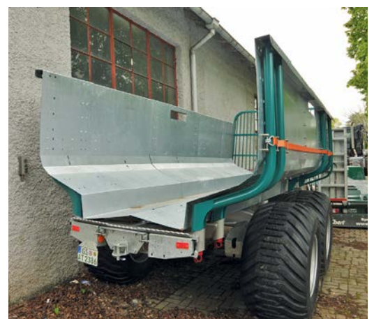
Rechts: Der Rückwagen ist für den Transport von Biomasse aufgerüstet. Die Bleche sind mit dem Rückekran schnell auf- und abzubauen.
