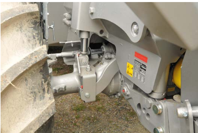
Unten: Die Vorderachse wird beim Einsatz des Krans automatisch hydraulisch gesperrt. So steht der Pm Trac sicher und fest.
