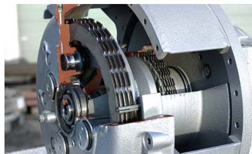
Lamellen-Haltebremse (links im Bild) und Lamellen-Kupplung (rechts) einer Pfanzelt-Getriebewinde.
