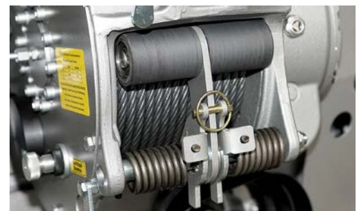
Seit Kurzem bietet Pfanzelt für die S-line-Modelle ein Langseilpaket mit einer Andruckrolle an.
