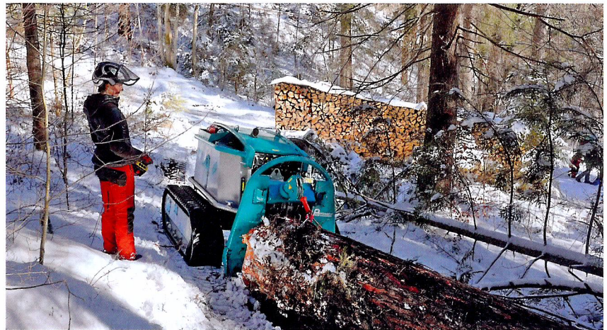
Die zwei neuen Modelle mit 50 und 75 PS können mit einer Seilwinde, die über eine Zugkraft zwischen 5 und 7,2 t verfügt, ausgestattet werden. Werkfoto
