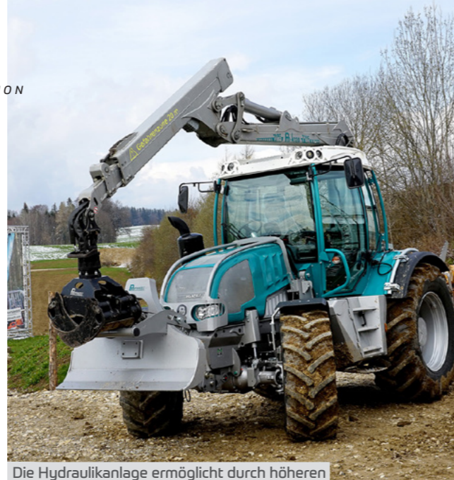
Die Hydraulikanlage ermöglicht durch höheren Öldurchsatz auch höhere Kranleistungen
