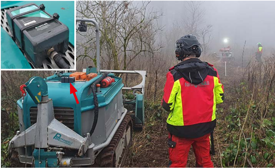
Die eingesetzten Moritz sind mit Datenloggern (Pfeil) ausgerüstet, die unter anderem Leistungs- und Verbrauchswerte erfassen. So kann das Projekt umfassend ausgewertet werden. Fotos: Pfanzelt Maschinenbau
