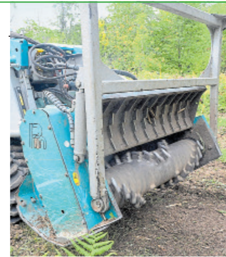
Der Antrieb der Forstfräse erfolgt über eine mechanische Zapfwelle. 40 Hartmetallzähne erledigen die Arbeit.
