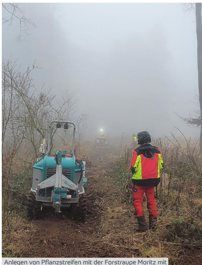
Anlegen von Pflanzstreifen mit der Forstraupe Moritz mit Forstfräse MAX
