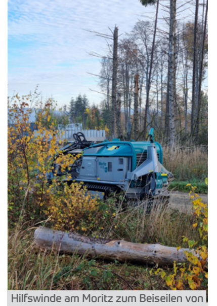
Hilfswinde am Moritz zum Beiseilen von Stämmen oder Stöcken und zur eigenen Traktionsunterstützung
