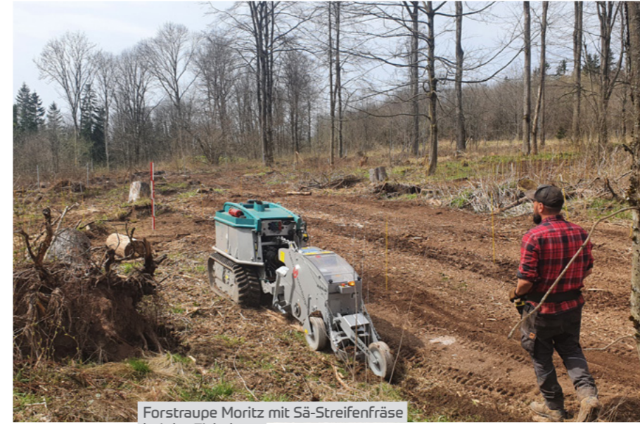
Forstraupe Moritz mit Sä-Streifenfräse bei der Eichelsaat
