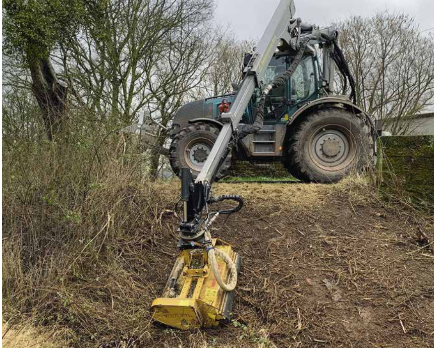
△ Sommereinsatz mit dem Mulcher. Eine zapfwellenangetriebene Hydraulikeinheit im Heck versorgt den Mulchkopf.
