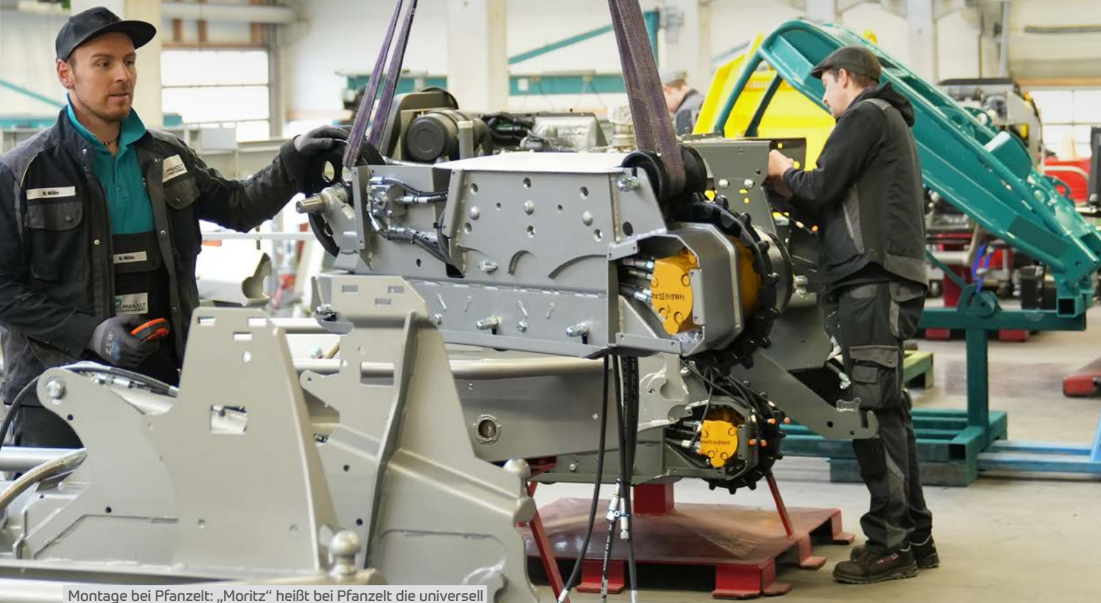
Montage bei Pfanzelt: „Moritz“ heißt bei Pfanzelt die universell einsetzbare Forstraupe.
