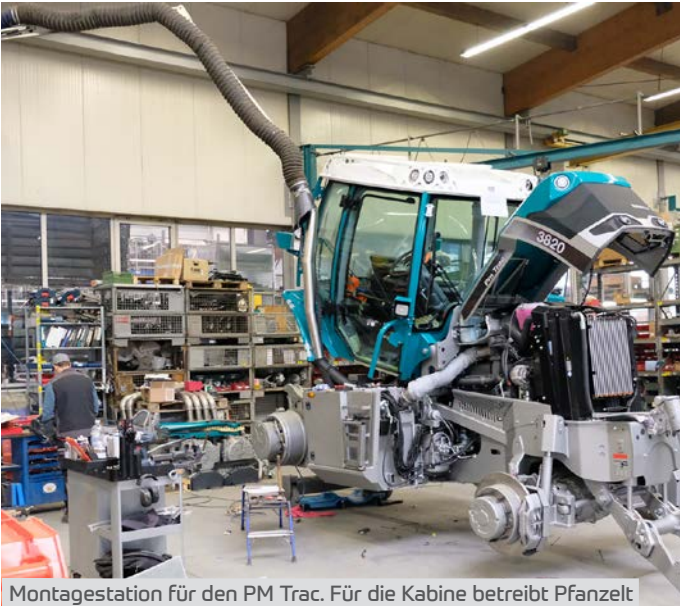
Montagestation für den PM Trac. Für die Kabine betreibt Pfanzelt sogar eine Teststation im Haus.
