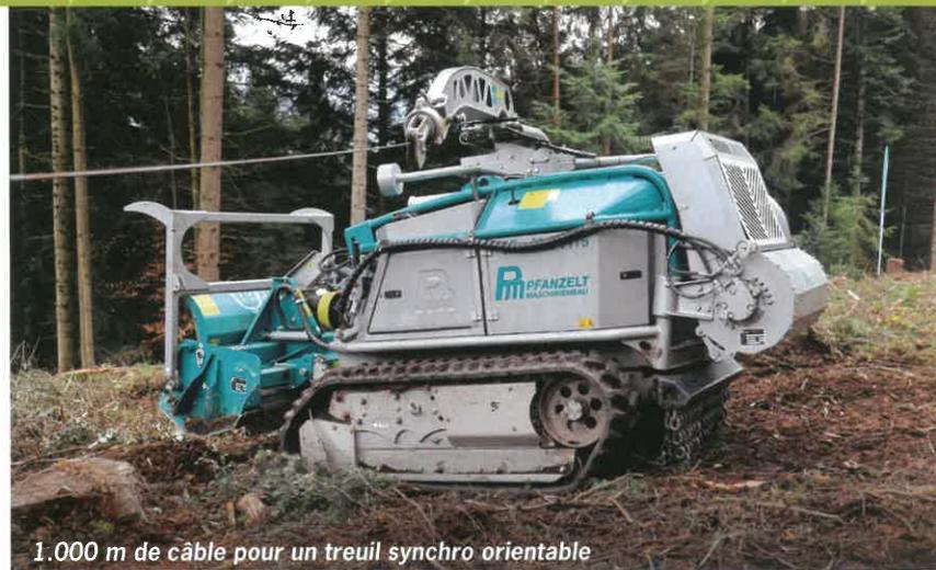
1.000 m de câble pour un treuil synchro orientable
