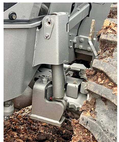
Die Vorderachse wird beim Kraneinsatz gesperrt.
