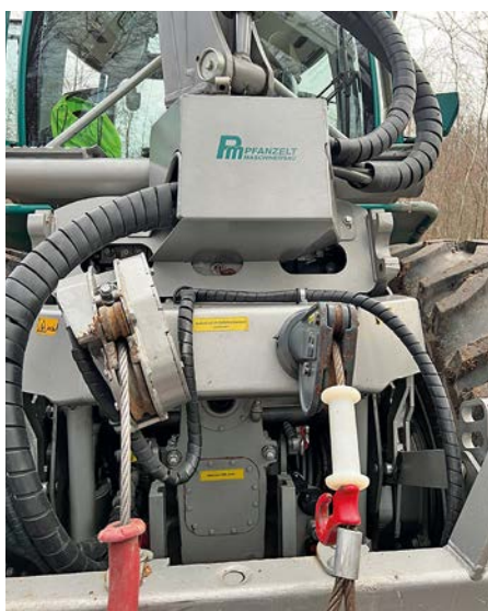
Die linke Trommel mit Seilausstoß.
