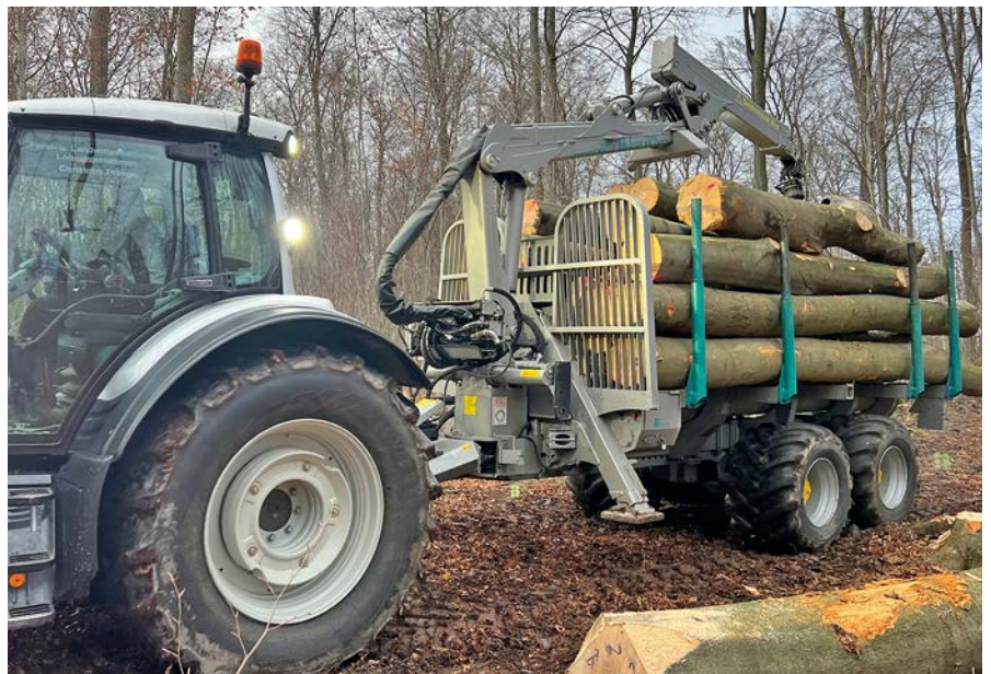
Die Abschnitte und das Industrieholz werden mit dem Rückeanhänger an den Weg gebracht.
