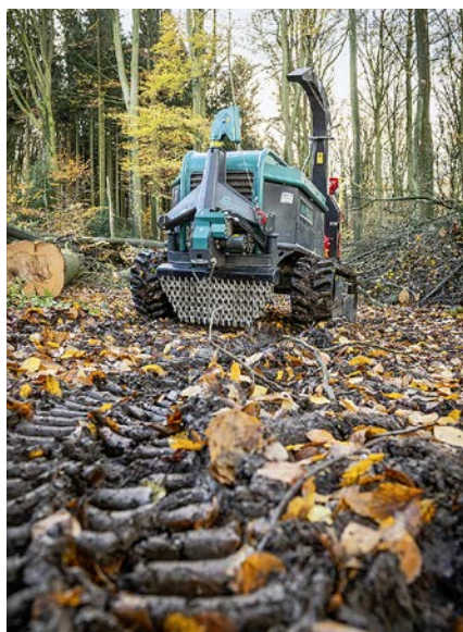
Mit einem Druck von nur 0,3 kg pro cm 2 verursacht der Moritz weniger Bodendruck als ein normaler erwachsener Mensch.
