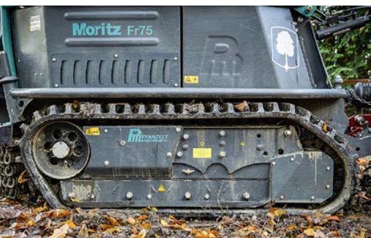
Die Kette wird bei dem neuen Modell hydraulisch über das Kettenleitrad gespannt.
