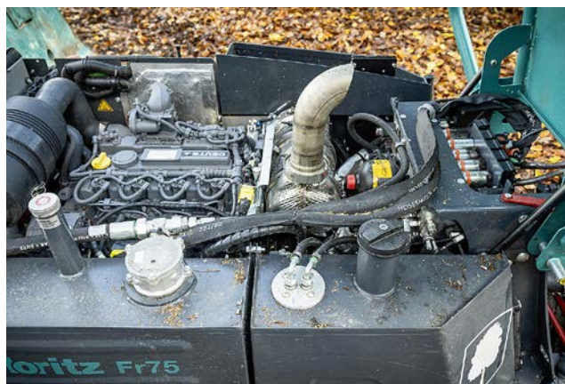
Der FR 75 wird angetrieben von einem Deutz 4 Zylinder Turbo.
