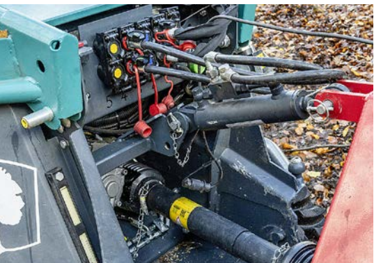
Dank 3- Punkt Aufnahme, Gelenkwelle und Steuergeräte können sämtliche Anbaugeräte verschiedener Hersteller angebaut werden.
