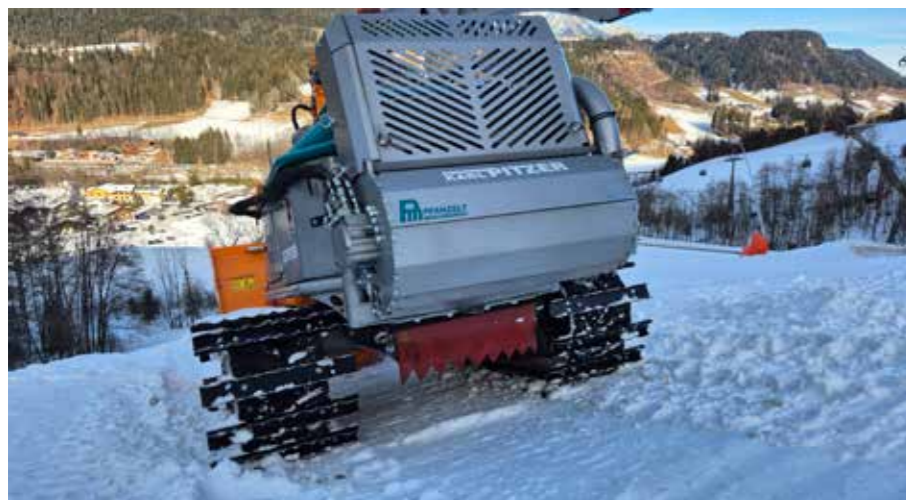
Neben den speziellen Bändern für den Einsatz des Moritz auf Schnee und Eis hat sich die Firma Pitzer an der Fronthydraulik einen Notanker montiert.
