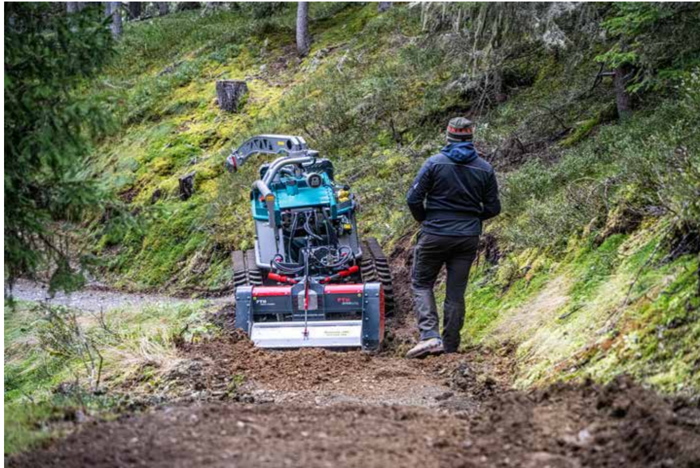
Alle Funktionen der Moritz lassen sich über eine ergonomische Funkfernsteuerung bedienen.
